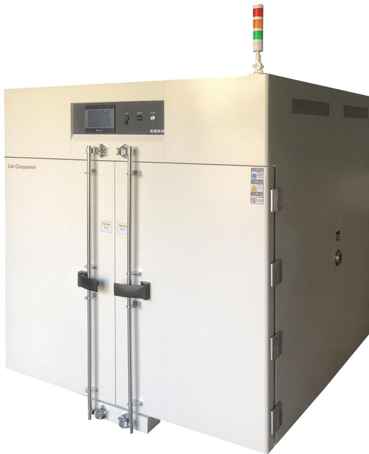
高温烘箱工作室为不锈钢结构。工作室内温度由温控仪自动控制，并有自动恒温及时间控制装置，并附设有超温自动停电及报警电路，控制可靠，使用安全。
